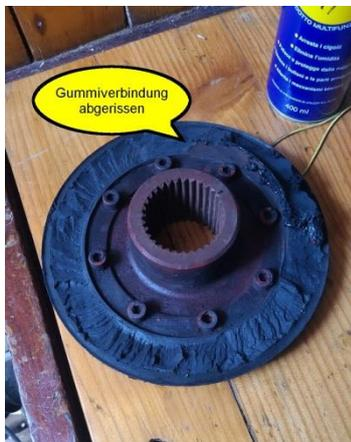
Um 11:59 erreicht mich von Luca die Nachricht mitsamt Foto der beschädigten Kupplungsscheibe. Dazu ein Bild mit der bereits eingebauten, neuen Kraftübertragung. Das Problem scheint gelöst – Gottseidank! Es gilt noch, das Getriebe wieder anzuf lanschen und das kurze Antriebswellenstück zu montieren. Eine happige Arbeit, aber Morgen müsste die „NORSEMAN“ eigentlich wieder zum Auslaufen bereit sein? Gerne warte ich auf diesen Bescheid.
